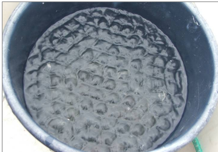
4. ábra Vízfelület, működő diesel motor által előidézett sajátrezgései
